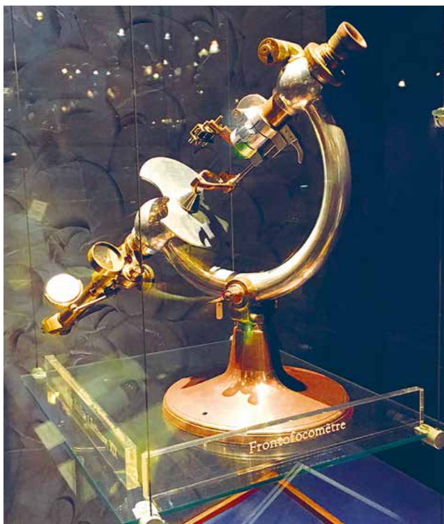
Der Scheitelbrechwertmesser misst die „Stärke“ der Brillengläser und gibt die Werte in Dioptrien an.
